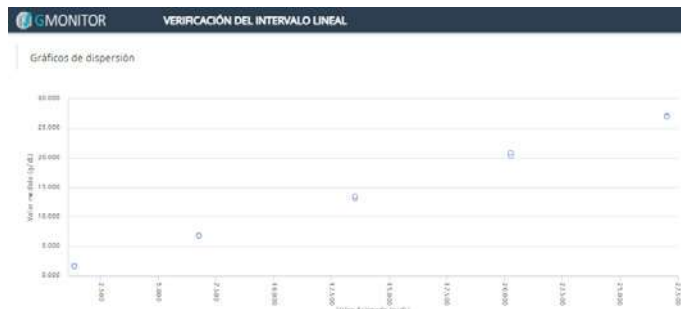
Figura 1 - Gráfico de dispersión correspondiente a la verificación del intervalo lineal de un procedimiento de medida que cuantifica la hemoglobina en sangre entera en g/dL. Sistema GMonitor, GMigliarino Consultores.
